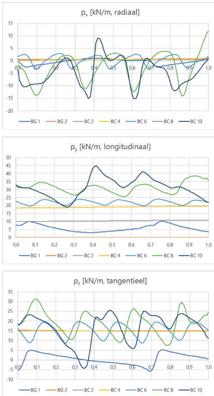
Figuur 5.30 / Reactiekracht p_x (radiaal), p_y (longitudinaal) en p_z (tangentiël) voor de klemstrip bij x = 0,1 m.
