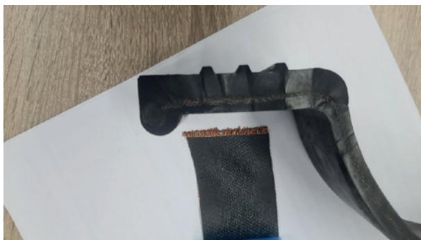
Figuur 2.14 / Detail omega met los stukje ongevulkaniseerd nylon inlagen.
