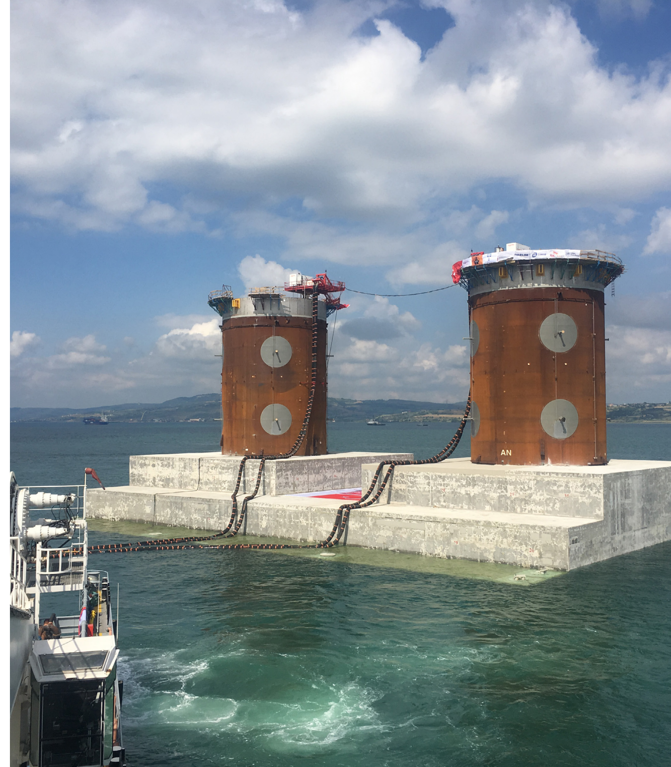
Ballast vessel gekoppeld met drijvende slangen aan caisson
